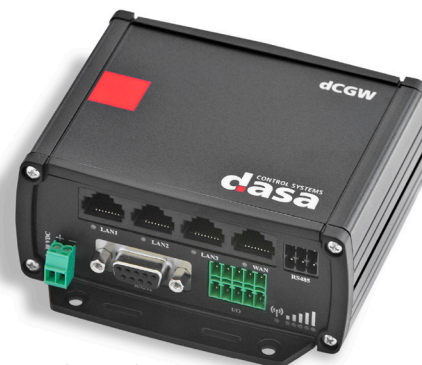
Dasa Connect Gate Way (dCGW) Gateway med LTE/3G/GSM internetuppkoppling. Enheten har intern GPS, 4 portars Ethernet-kontakt och Wifi.
